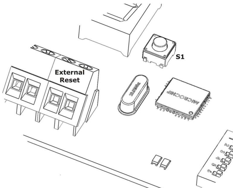
Il pulsante S1 viene utilizzato per il reset del concentratore dopo una segnalazione di allarme. E' possibile effettuare il reset anche da dispositivo esterno (combinatore GSM, ecc...) utilizzando il morsetto "External Reset" (contatto normalmente aperto).
