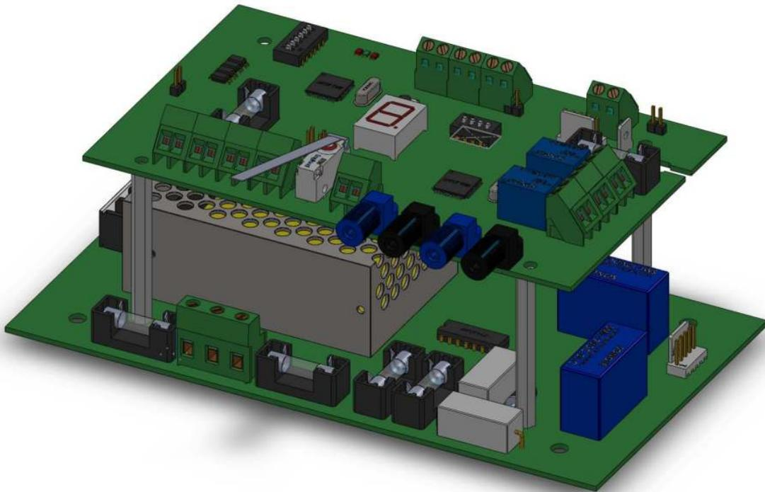
Il modulo concentratore ALM-6813/6812 gestisce 2 linee a fibra ottica plastica ( POF - Plastic Optical Fiber) da 200 metri lineari , mediante 2 Loop. Può funzionare in modalità stand-alone o in modalità centralizzata su BUS RS-485.
