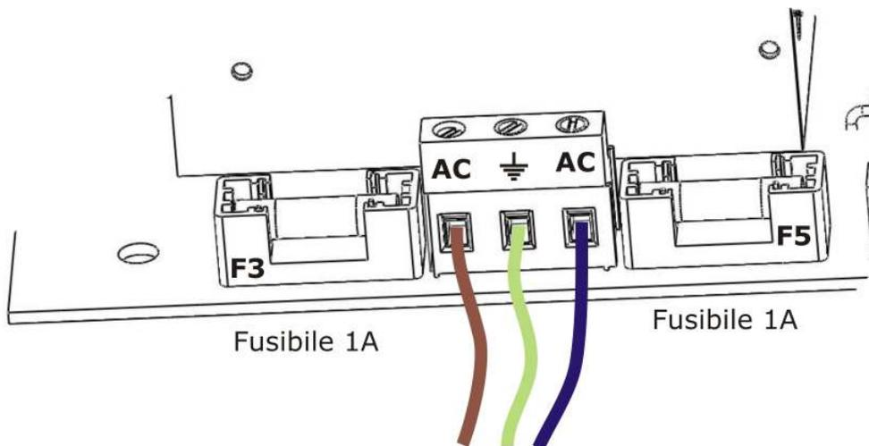
**Importante:** Tutti i concentratori devono essere collegati a terra tramite il morsetto di alimentazione 230V. Il mancato collegamento può causare il danneggiamento in caso di scariche atmosferiche o sovratensioni.
