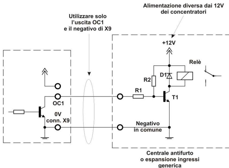
La problematica principale della prima modalità di collegamento descritta precedentemente, è che il relè risulta sempre attivo aumentando l'assorbimento per ogni concentratore di circa 20mA (in base al tipo di relè collegato). Per risolvere questo problema basta utilizzare, oltre al relè, alcuni componenti di facile reperimento ed utilizzo.
