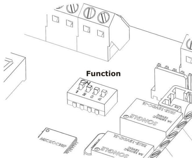
Il microswitch 1 si utilizza per disattivare il loop fibra 2. Questa funzione viene utilizzata quando sul concentratore si utilizza solo un loop fibra.
