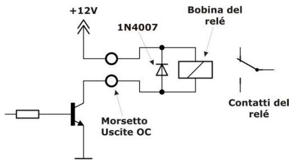
Questo è la modalità più semplice di collegamento di una uscita open collector con chiusura a negativo.
