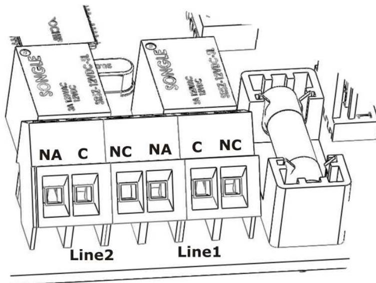
Il concentratore ha a bordo due relè di segnalazione. Line1 per il loop1 (TX1-RX1) e Line2 per il loop2 (TX2-RX2). I due relè si attivano in caso di rottura o taglio della fibra.
