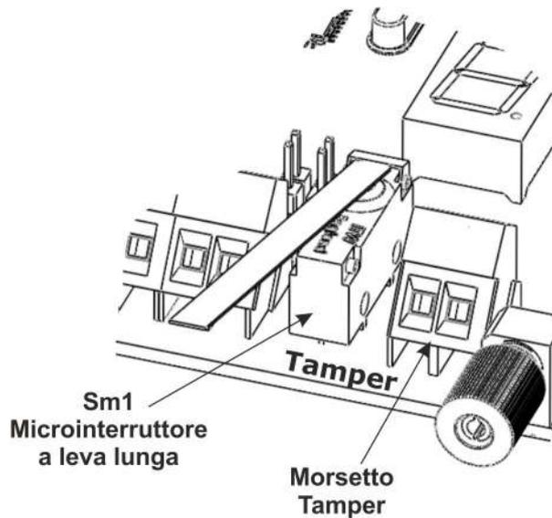
Il concentratore ha al suo interno un microswitch a leva lunga per la protezione antiapertura del contenitore. Se lo si utilizza in modalità di funzionamento su Bus, il concentratore segnalerà la manomissione alla centrale tramite il BUS.
