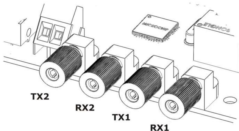
Il concentratore è dotato di 4 connettori fibra. 2 per la parte TX e 2 per quella RX (non è necessario effettuare una perfetta lappatura prima della connessione della fibra).
