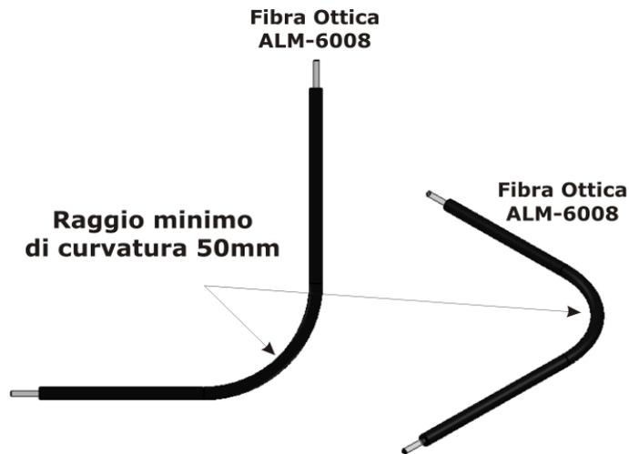
La lettura ottimale del segnale attraverso la fibra, è tarata su una lunghezza massima di 200mt circa. Se si utilizzano lunghezze superiori, la trasmissione/lettura del segnale può risultare inferiore al valore di soglia impostato sul concentratore. In questo modo saranno possibili false segnalazioni di allarme taglio fibra. Perciò, la fibra ottica plastica (ALM-6008) viene fornita in bobine da 200mt.
