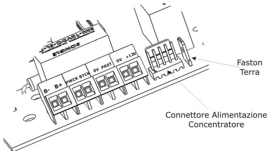
Il concentratore viene alimentato tramite il connettore 5 poli. A bordo dell'alimentatore è presente anche un morsetto a 8 poli.
