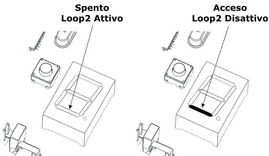
I microswitch 3 e 4 servono per attivare la funzione di controllo della lettura della fibra. In questo modo è possibile accertarsi della ottimale lettura/trasmisione del segnale attraverso la fibra. Attivata la funzione (per singolo canale), su display 7 segmenti, verrà visualizzato un valore che può andare da 0 fino a 9.
