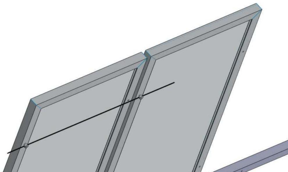
La fibra ottica deve essere passata attraverso i quattro passacavo del contenitore. Finita l'installazione della fibra, i passacavo dovranno essere serrati.
