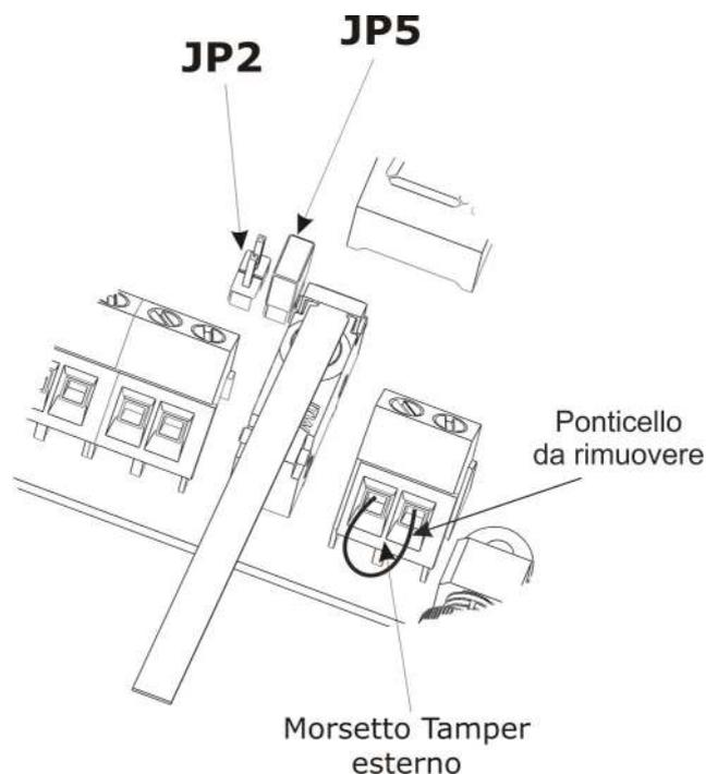
**Nota: Sia nella modalità di funzionamento su BUS che in stand-alone, dopo l'installazione e test del concentratore, bisognerà rimuovere il ponticello sul morsetto tamper esterno. Lasciando il ponticello collegato al morsetto il tamper rimarrà inattivo.**
